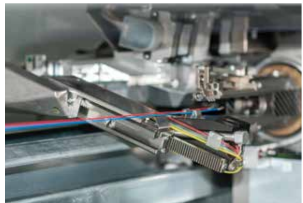
▲ Transferbrücke Mit motorisierten Achsen
