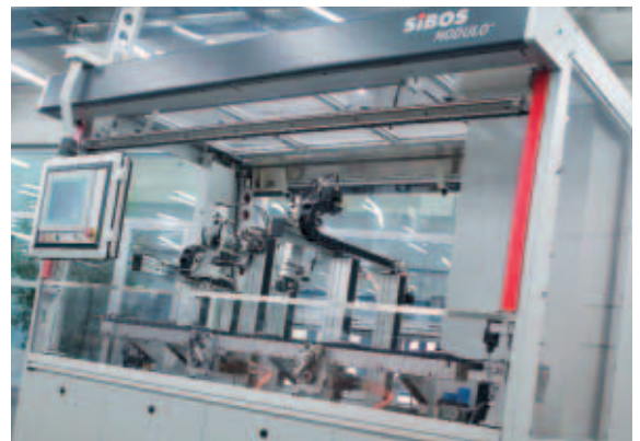
Die Verarbeitung von flexiblen Flachleitern und Folienleitern ist anspruchsvoll und erfolgt meist maschinell.
