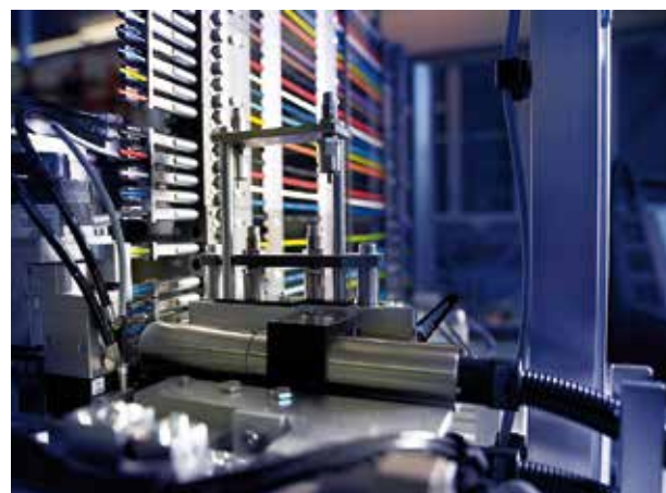
▲ Automatischer Druckkopfwechsler auf Zeta Kabelwechsel ohne Operatoreingriff dank Mittenzentrierung der Schrift
