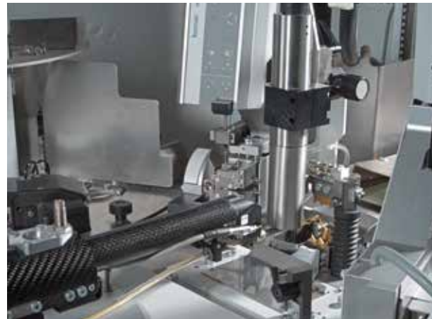
▲ ims 295 auf Alpha 455 Minimaler Nullschnitt, da der Druckkopf nahe am Schneidkopf angeordnet ist
