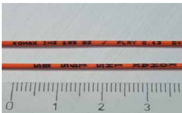
▲ Bedruckungsbeispiel ims 295 BS, 0.13mm 2 (AWG26) Kabel
